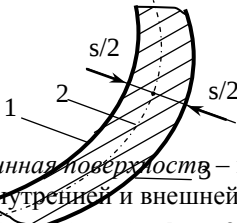
Рис. 3.1. Схема образования оболочки: 1 – внутренняя стенка; 2 – срединная поверхность; 3 – наружная стенка.
