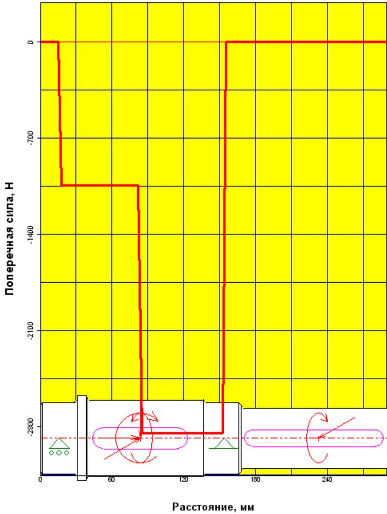
Рисунок 5.7 Поперечной силы в вертикальной плоскости
