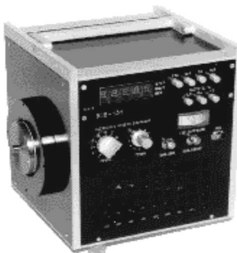
Рисунок 17.63 - Вибростенд ВСВ –131Ех
