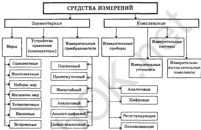
Рис. 3.1. Классификация средств измерений по их роли в процессе измерения и выполняемым функциям
