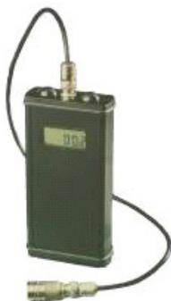
Рис. 4.17. Индикатор состояния подшипников ИРП-12
