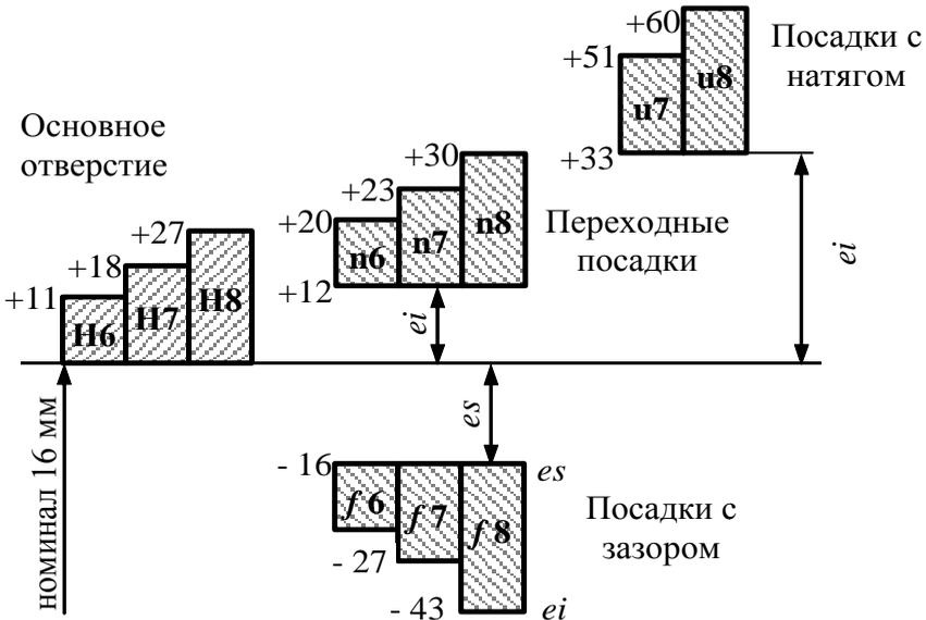
Рис.2.1.5. Схема расположения полей допусков, иллюстрирующая образование посадок
