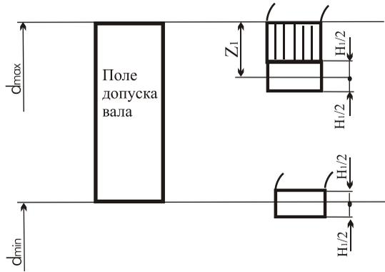
Рис. П1.4. Схемы расположения полей допусков калибров
