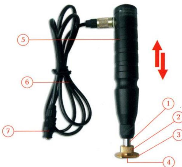
Рис. 4. Датчик ультразвуковой твердомера МЕТ-УД : 1-втулка;
