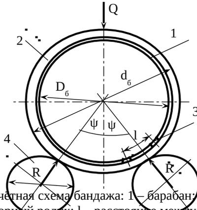
Рис. 3.3. Расчетная схема бандажа: 1 – барабан; 2 – бандаж; 3 – башмак; 4 – опорный ролик;  $l$  – расстояние между башмаками;  $D_6$  – наружный диаметр барабана;  $d_6$  – наружный диаметр бандажа;  $h_6 \times b_6$  – сечение бандажа;  $d_{op}$  – диаметр опорного ролика;  $Q$  – усилие на опору;  $R$  – реакция опорного ролика;  $\psi$  – угол размещения опорного ролика ( $\psi = 30^\circ$ )
