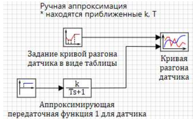
Рисунок А.1.6 – Схема для аппроксимации кривой разгона датчика
