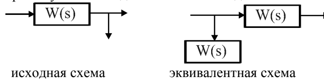
Рисунок 6 - Перенос узла с выхода звена на его вход
