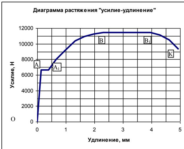
Рис. 1.2. Диаграмма растяжения образца из отожжённой стали.
