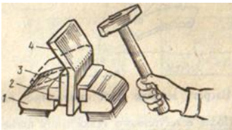
Рис. 2.8. Гибка с оправкой
