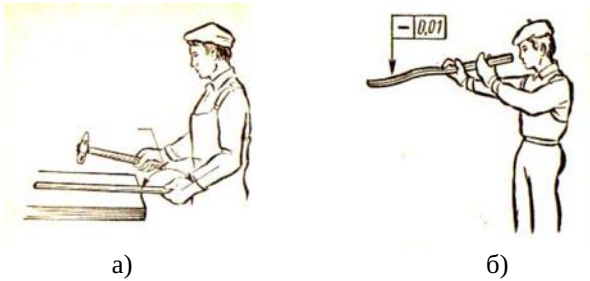
Рис. 2.1. Правка полосы: а) проверка высоты правильной плиты по росту; б) проверка изогнутости полосы «на глаз»
